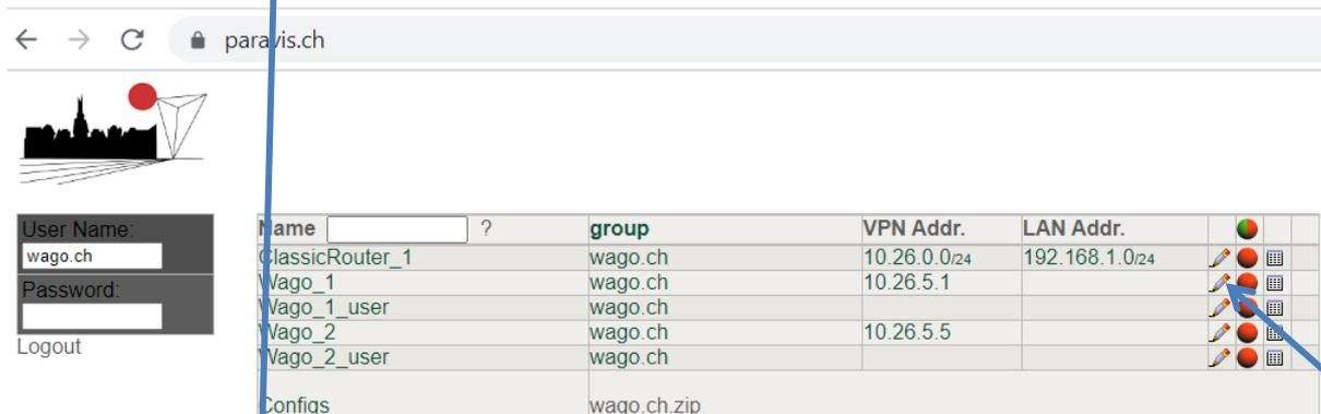
Bild oben: Zuerst ein möglicher VPN Classic\_Router1, danach alles VPN Clients . davon sind Wago\_1 und Wago\_2 VPN Clients mit statischer VP Adresse. Wago\_1\_user und Wago\_2\_user sind normale Bediener VPN Clients. Click auf das Bleistift bei Wago\_1 öffnet unteres Bild.
